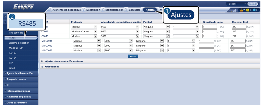
Figura 6-90 Configuración de los parámetros RS485
