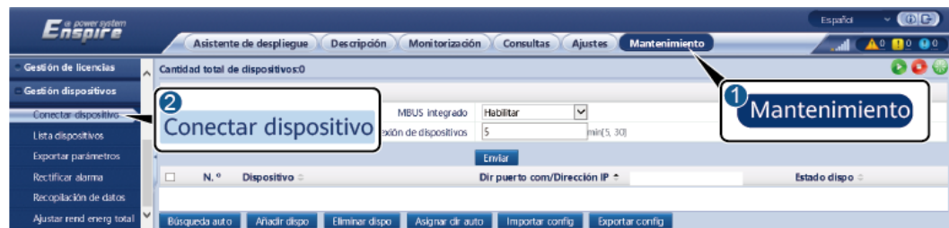
Figura 6-41 Configuración de parámetros para el MBUS integrado
