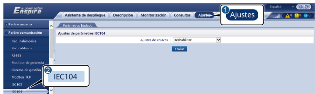
Figura 6-33 Configuración de los parámetros de IEC104
