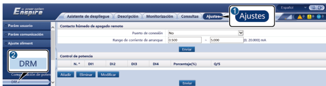
Figura 6-85 Cómo configurar los parámetros de DRM
