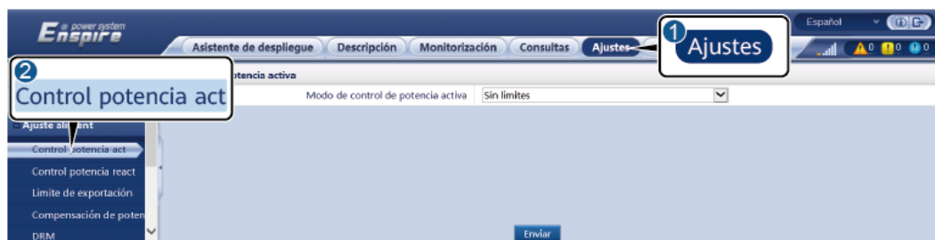
Figura 6-74 Control de potencia activa
