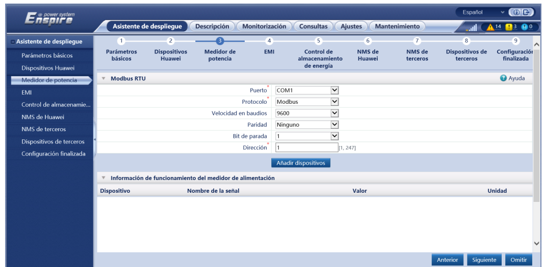
Figura 6-20 Configuración de los parámetros de los contadores
