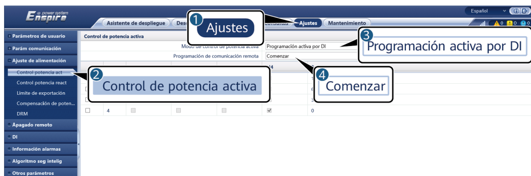
Figura 6-75 Programación activa por DI
