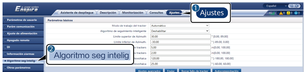
Figura 6-69 Parámetros del algoritmo de seguimiento inteligente
