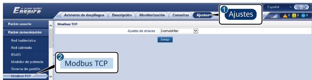
Figura 6-36 Configuración de los parámetros de Modbus TCP
