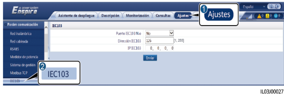
Figura 6-59 Configuración de los parámetros de IEC103
