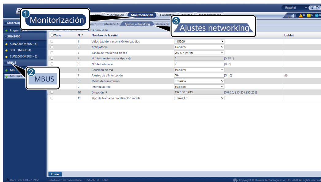
Figura 6-44 Configuración del networking MBUS externo
