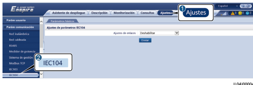
Figura 6-37 Configuración de los parámetros de IEC104
