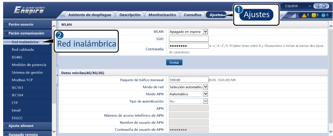
Figura 6-28 Configuración de parámetros de datos móviles
