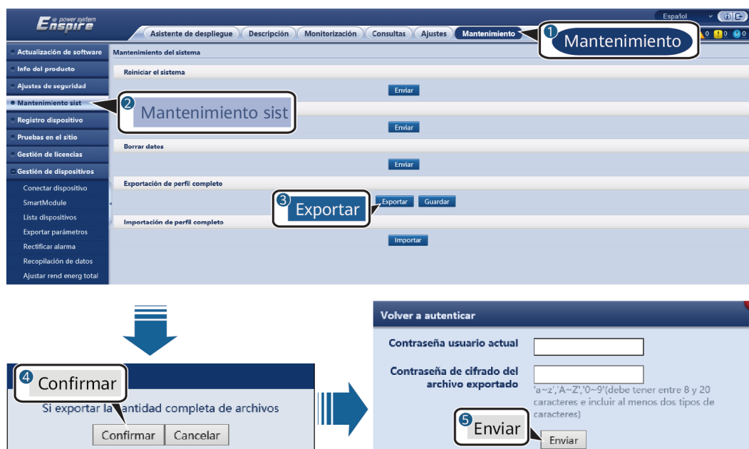
Figura 7-4 Exportación de archivos de configuración completos
