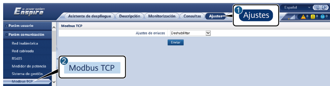
Figura 6-39 Configuración de los parámetros de Modbus TCP
