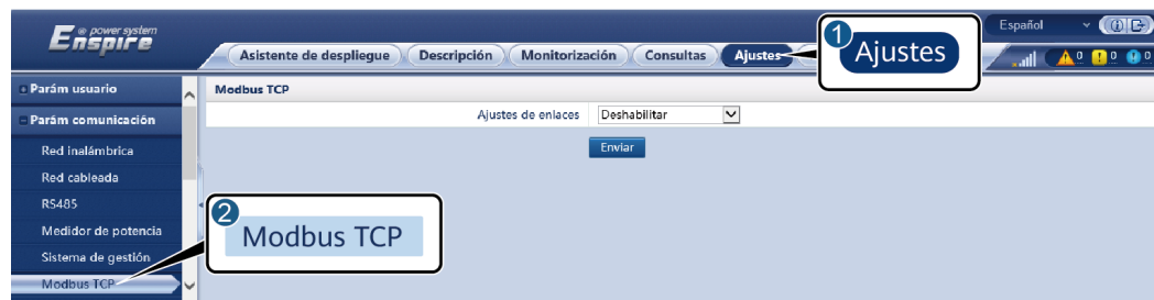
Figura 6-32 Configuración de los parámetros de Modbus TCP
