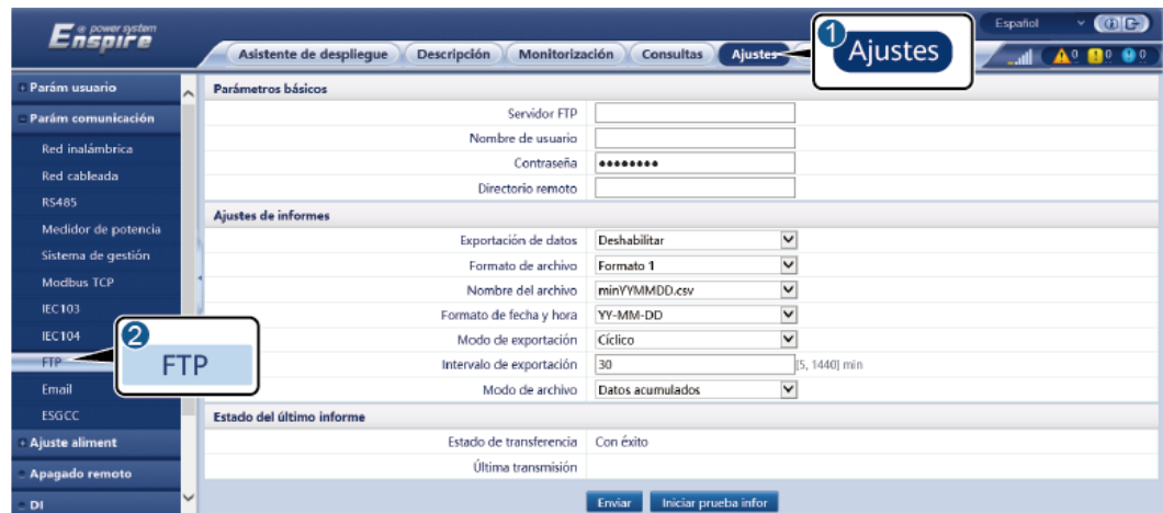
Figura 8-3 Configuración de los parámetros de FTP
