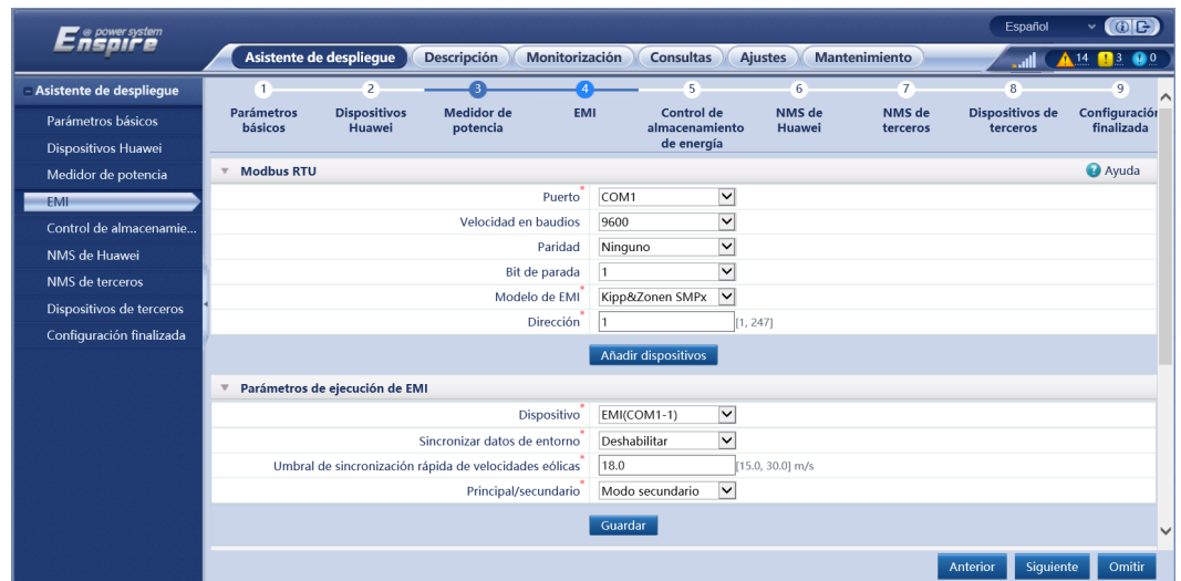
Figura 6-12 Configuración de los parámetros del EMI
