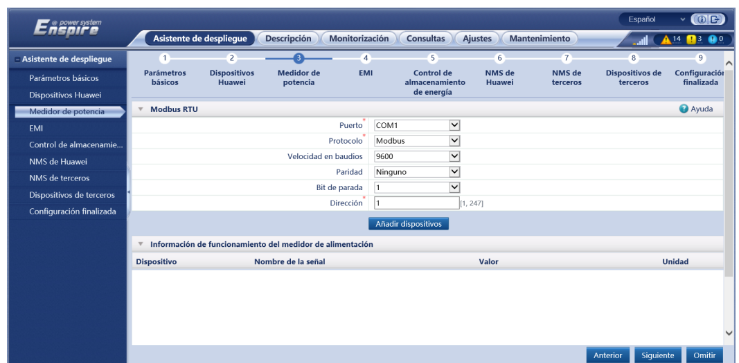
Figura 6-11 Configuración de los parámetros del contador de potencia
