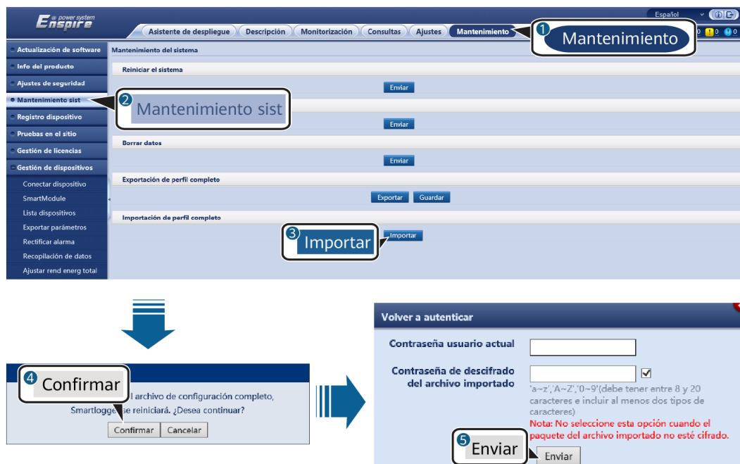
Figura 7-5 Importación de archivos de configuración completos
