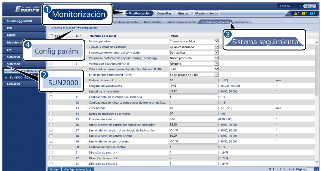
Figura 6-48 Cómo establecer los parámetros de configuración (sistema de seguimiento)
