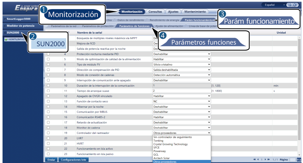
Figura 6-47 Configuración del controlador del sistema de seguimiento
