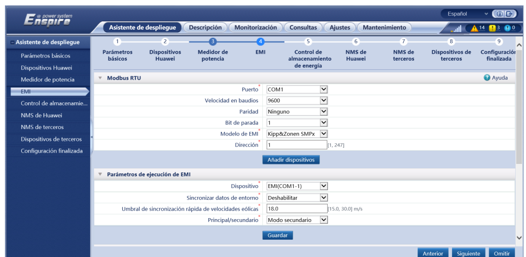
Figura 6-21 Configuración de los parámetros de los EMI
